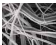
Микроволокна утеплителя Тинсулейт®
